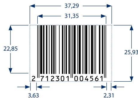
Abmessungen eines EAN-13 in Nominalgröße (X-Modul 0,33 bzw. Vergrößerungsfaktor 1)
